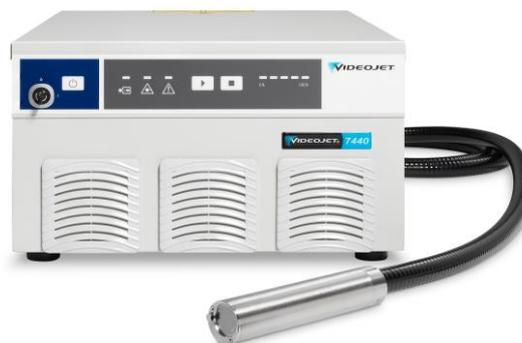
Die Faserlaseroptionen Videojet 7340 und 7440 sind mit einer Reihe von Optionen erhältlich, die die Integration noch einfacher machen: 0°- und 90°-Markierköpfe, 3 Brennweiten und 2 Optionen für die Länge der Versorgungsleitung (3 m oder 10 m).
